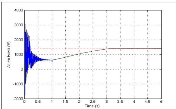
Fig. 9. Active power (W), Pf ≈ 1400W
